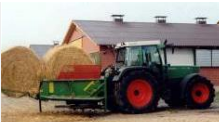
Abbildung 113: Einstreumaschine für die Putenmast
