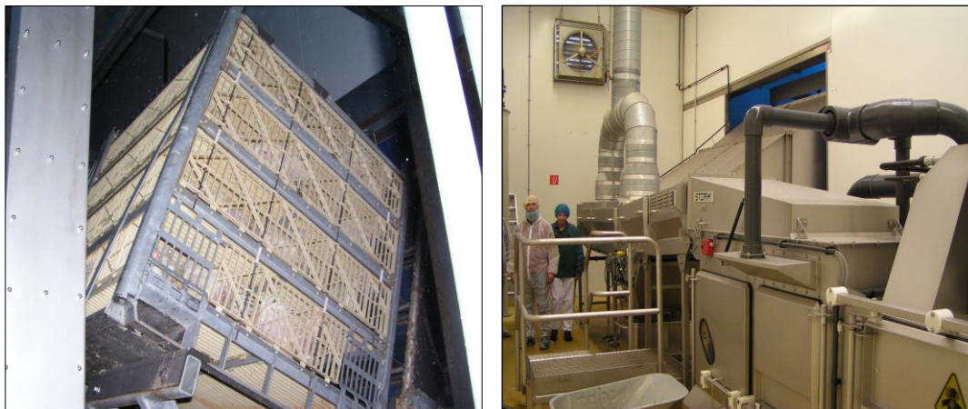
Abbildung 47: Mittels automatischer Kippvorrichtung werden die Masthühner entladen und dem Betäubungstunnel zugeführt
