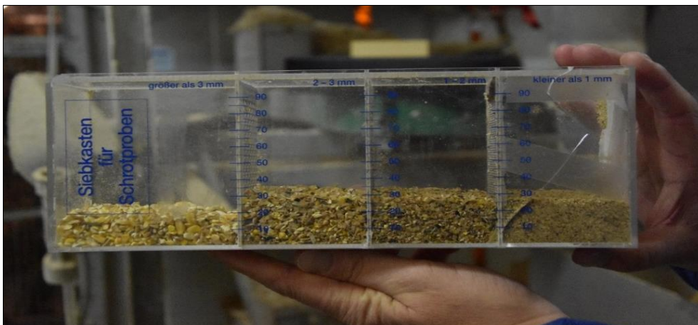
Abbildung 76: Siebkasten mit einer gängigen Junghennenmischung (Quelle: Projekt „Layer HACCP“)
