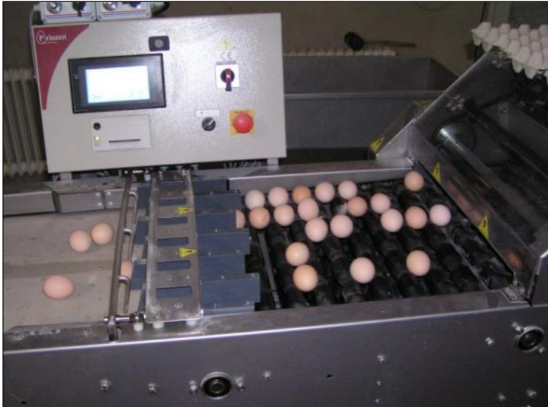
Abbildung 20: Sortier- und Wiegeeinrichtung für Bruteier von Masteltern
