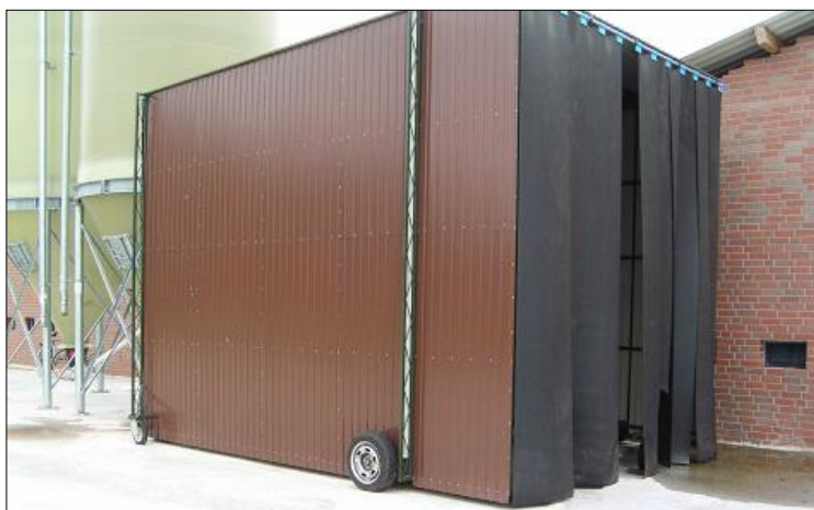
Abbildung 44: Fangvorrichtung – Tunnel verhindert das Ausleuchten des Stalles
