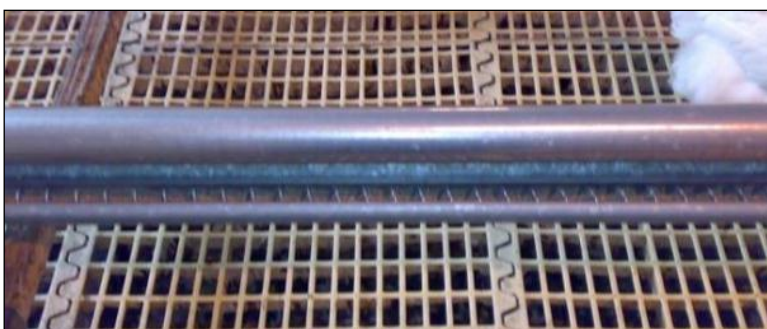
Abbildung 25: Bridomat – Längstrog mit Futterspirale und Rollenbegrenzung
